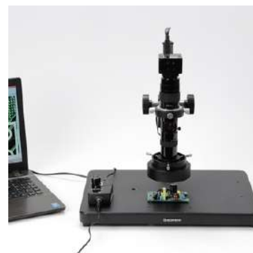
Microscope USB với độ phóng đại cao 3 Megapixel FZ300PC3
